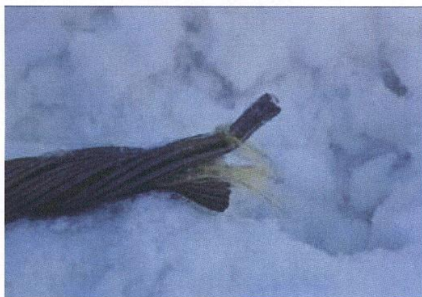
Рисунок 3. Характер разрушения кабеля в процессе испытаний.
