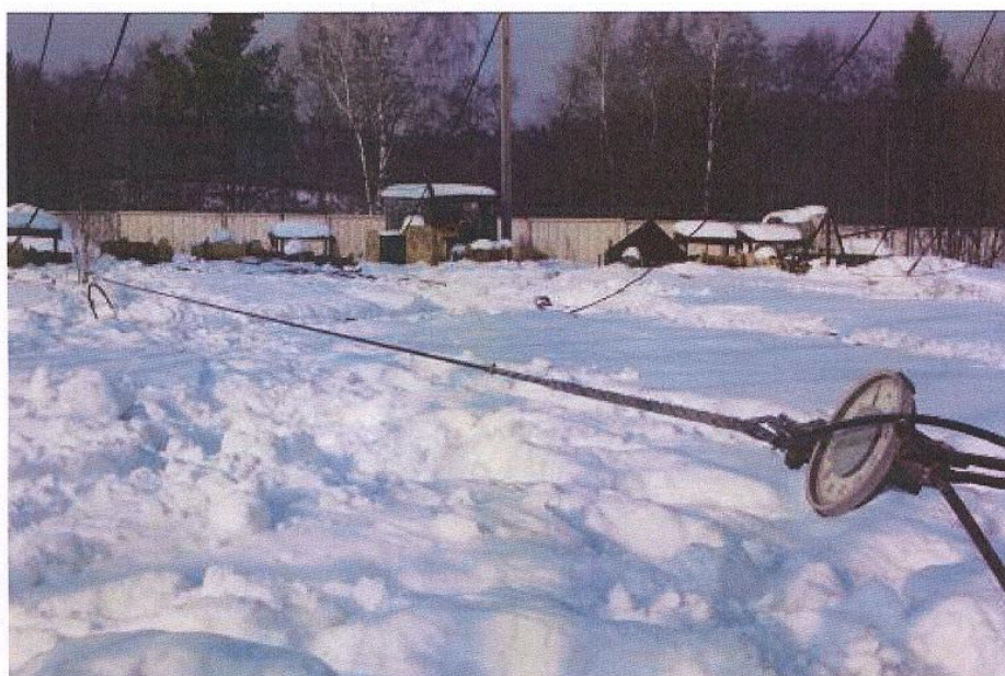
Рисунок 2. Общий вид стенда для испытаний волоконно-оптического кабеля типа ОКСД-01-6х8ЕЗ-(60,0) на стойкость к растягивающим нагрузкам.
