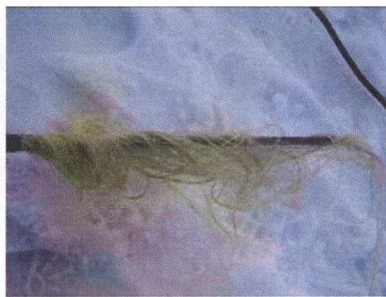
Рисунок 3. Характер разрушения кабеля в процессе испытаний.
